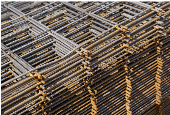
Baustahlmatten, hergestellt mittels Umformwalzen
